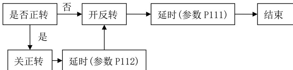
(1) M04 指令使主轴反转继电器(由 M04 输出口控制)吸合，接着 S 功能输出模拟量，控制主轴逆时针方向旋转。
