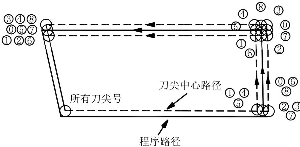
图 6-2-6-2 G94 刀尖半径半径补偿
