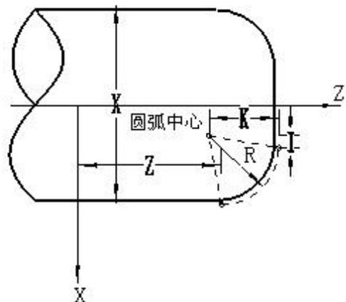
用地址 **X**, **Z** 或者 **U**, **W** 指定圆弧的终点, 用绝对值或增量值表示。增量值是从圆弧的始点到终点的距离值。圆弧中心用地址 **I**, **K** 指定。它们分别对应于 **X**, **Z** 轴。但 **I**, **K** 后面的数值是从圆弧始点到圆心的矢量分量, 是增量值。
