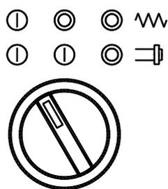
三位开关分左侧、中间、右侧三个位置状态，当由左侧位置拨到右侧位置，再由右侧位置拨到左侧时其控制顺序为：
