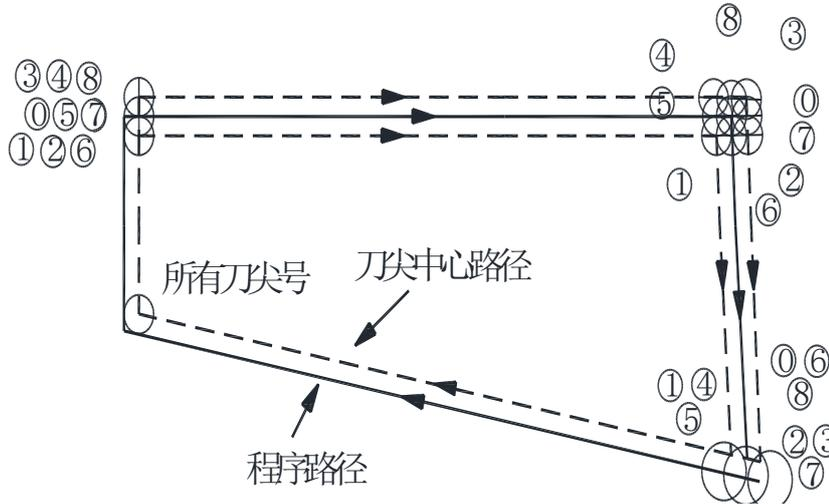
图 6-2-6-1 G90 刀尖半径半径补偿
