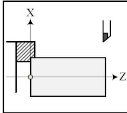
图示：后刀座的坐标系
