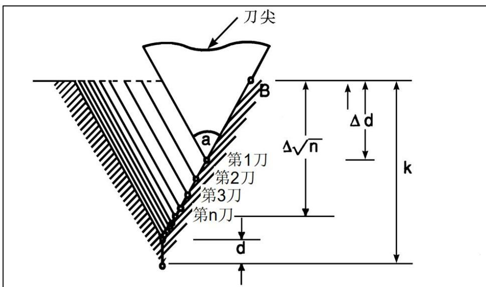
**例：G76 螺纹复合切削循环示例：**
