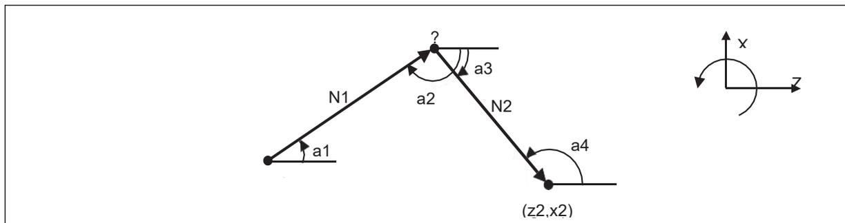
1. 角度为与所选平面的第 1 轴(水平轴)方向所成的角度, 以逆时针方向(CCW)为正, 以顺时针方向(CW)为负;
