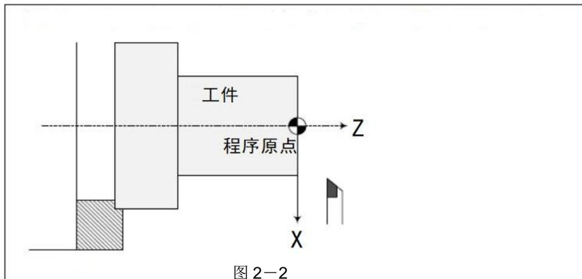
加工图纸上的坐标系和 CNC 指定的坐标系一致时
